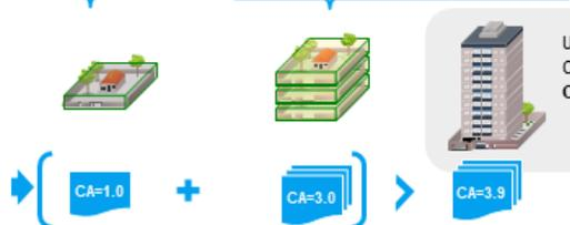
Um prédio com 3.120m<sup>2</sup> de Área Construída Computável admite o CA=3.9, por isso sua construção é possibilitada no terreno representado. No entanto, ...
